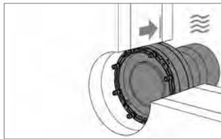
Die Dichtungseinsätze müssen in der Dichtebene der Wand positioniert werden. Sollten Unklarheiten hinsichtlich der Lage der Dichtebene vorliegen, ist die Vorgehensweise mit dem Planer bzw. dem Wand-Hersteller abzustimmen.
