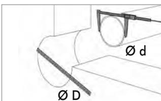
Durchmesser von Kernbohrung bzw. Futterrohr und der Medienleitung bestimmen und mit den Angaben auf dem Karton abzugleichen.
