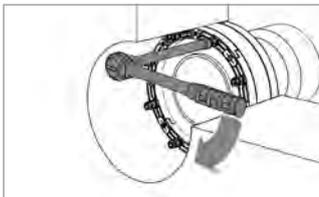
Zur Endmontage des Dichtungseinsatzes die Muttern (SW 10 oder SW 13 bei DN300) anziehen.
