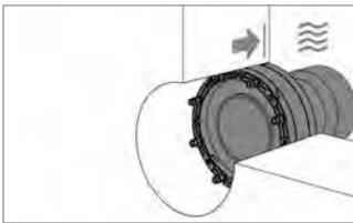
Die Dichtungseinsätze in Kernbohrung/Futterrohr einschieben bis der Dichtungseinsatz etwa bündig mit der Außenwand (Wasser-/Druckseite) abschließt.
