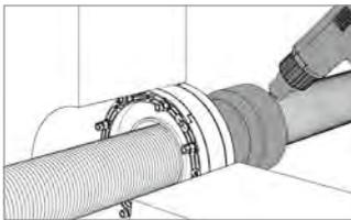
Hinweis: Vor dem Verschrumpfen ist ggf. die Oberfläche der Rohrleitung/des Kabels z.B. mittels Schleifpapier quer zur Axialrichtung der Leitung zur besseren Haftung der Rohrschrumpfmuffe aufzurauen (dies ist vorab mit dem Leitungshersteller abzustimmen). Anschließend Aufschrupfen der Schrumpfmuffe mit einem Heißluftgerät. Die Rohrleitung/das Kabel ist ggf. gegen zu starkes Erhitzen zu schützen, damit keine Beschädigung auftritt.
