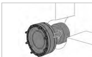
Dichtungseinsätze sollten mit den Spannmuttern zur „wasserabgewandten Seite“ ausgerichtet (Schrumpfmuffe zur Wasserseite) und möglichst weit zur „Wasserseite“ montiert werden, damit das Verschrumpfen problemlos funktioniert.
